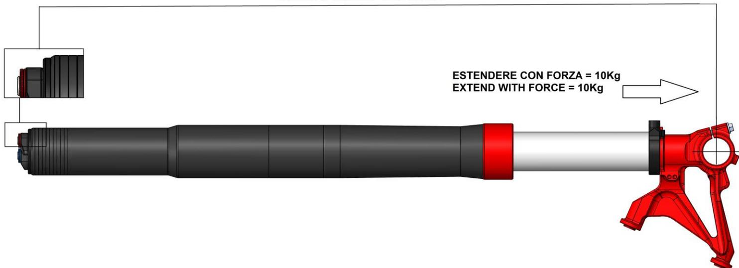
VITE DI REGOLAZIONE DEL PRECARICO
