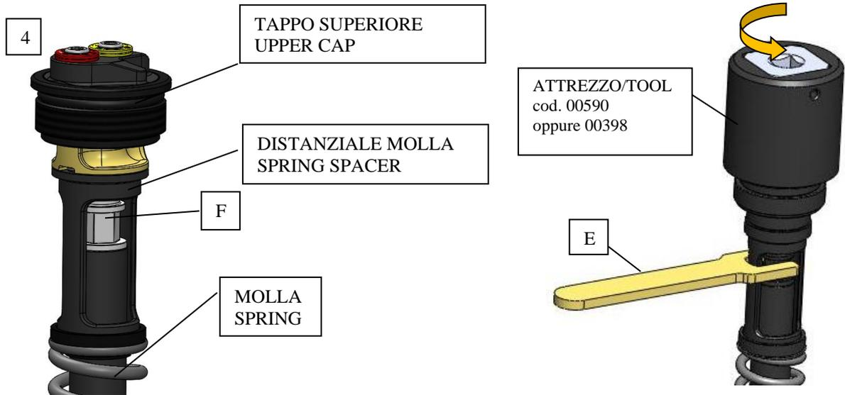
13- Fissare la cartuccia EBH direttamente sul piedino forcella come da *schema 1*. All' estremità "G" inserire una chiave a brugola da 19mm e serrare a 28Nm.
