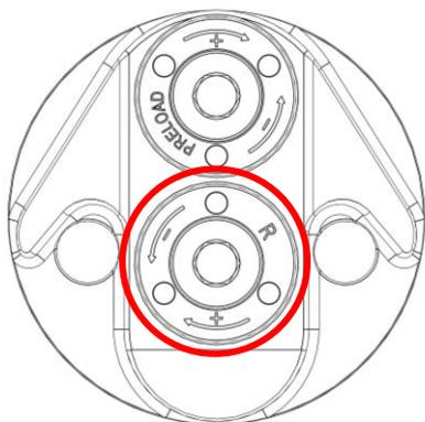
**ATTENZIONE:** per manovrare la regolazione è necessario l'ausilio di una chiave a brugola ch4; fare attenzione a non forzare i finecorsa della regolazione.
