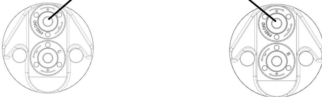
I valori di precarico sono tanto importanti quanto la quota di sfilamento delle forcelle. Il precarico definisce l'altezza a terra della moto, e l'assetto dinamico in curva quindi i valori di angolo forcella, avancorsa ecc. che caratterizzano il comportamento del veicolo. **Generalmente i valori di precarico ottimali vanno da 3 a 8mm.** Per ottimizzare la regolazione del precarico vedi paragrafo "REGOLAZIONE E MISURAZIONE DEI SAG".
