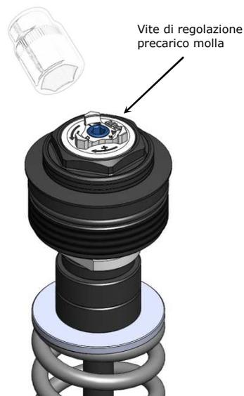
La regolazione del precarico molla può essere eseguita mediante una comune bussola con bocca esagonale da 17mm.
