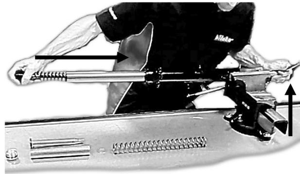
14. Posizionare la cartuccia in verticale. Versare la quantità di olio Bitubo cod. 997630 indicata nella tabella "1" nella sezione SET-UP DI BASE (pag.1). Eseguire alcune compressioni ed estensioni della canna forcella per permettere il corretto caricamento dell'olio.
