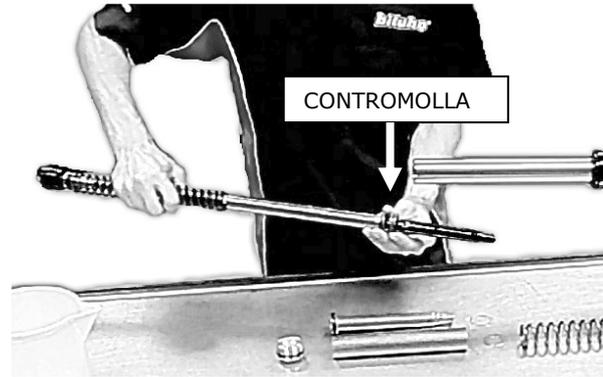
13. Mantenendo lo stelo sul fondo del fodero inserire la cartuccia BITUBO dentro alla forcella e fissarla con la vite a brugola e rondella originali, serrando adeguatamente con la coppia di serraggio indicata dalla casa madre.
