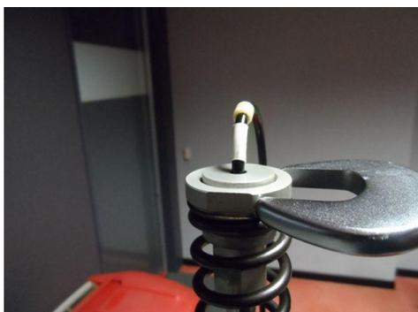
3. Svitare anello premimolla mediante chiave CH38mm.
