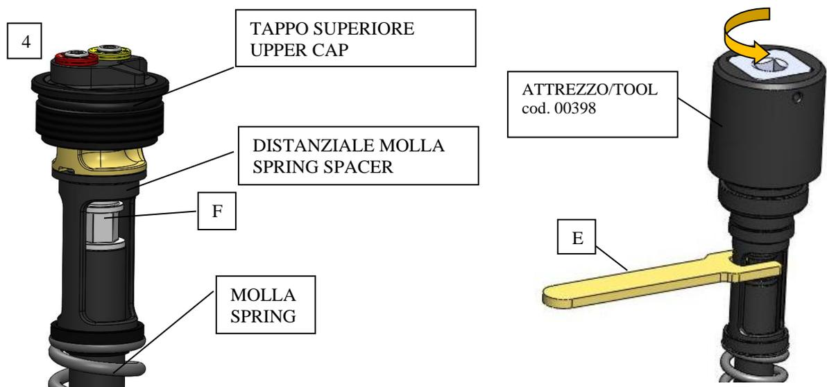
23- Inserire la cartuccia completa all'interno del gambale forcella, e fissarla con l'attrezzo speciale fornito nel Kit cod.00397 inserendolo dalla parte che si accoppia con il tappo inferiore cartuccia "C" (vedi schema 2 a pag.13. Dall'altra estremità "G" inserire una chiave a brugola da 19mm e serrare a 28Nm.
