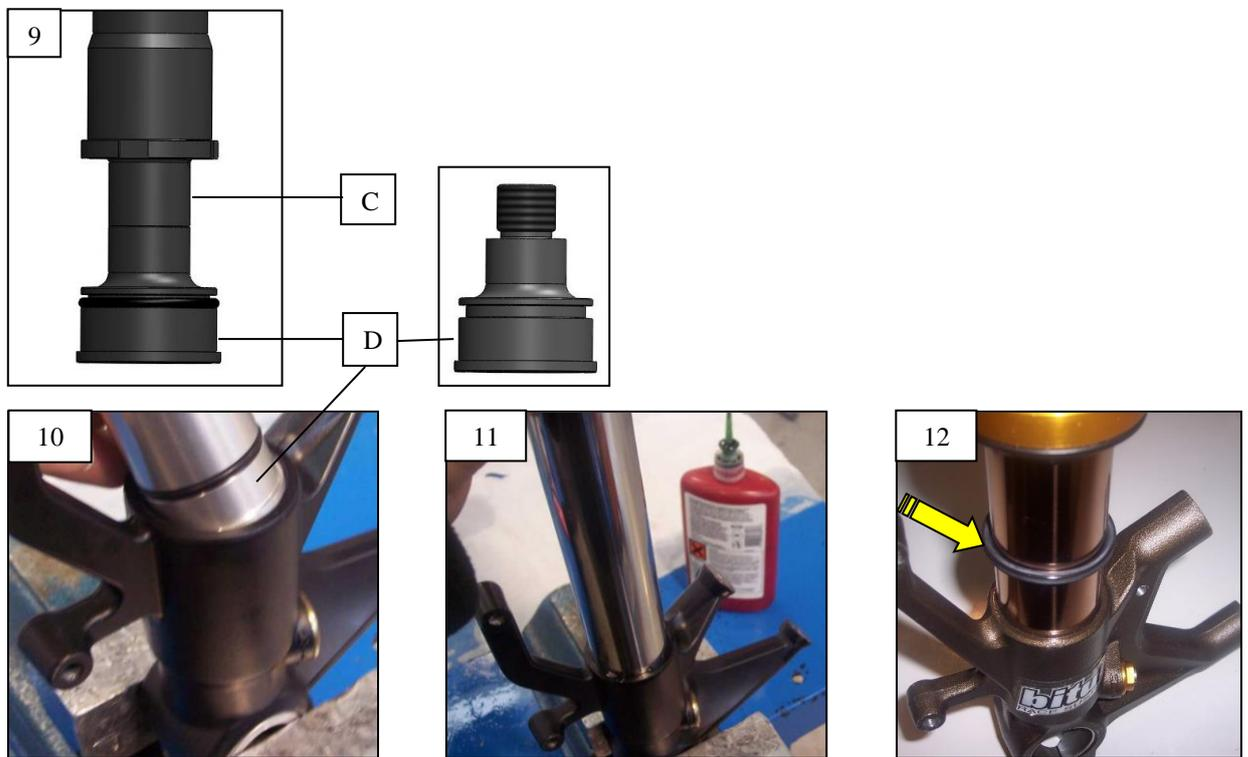
19- Cospargere con colla frena filetti a resistenza media (esempio Loctite 242 o equivalente) la filettatura dello stelo, avvitare lo stelo forcella sul piedino, e stringere a fondo servendosi della chiave 00243 + boccia 00324 (steli forcella Ø41mm) o 00323 (steli forcella Ø43mm). (foto 11)
