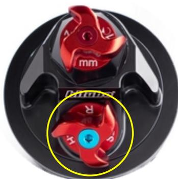
**ATTENZIONE:** per manovrare la manopola di regolazione non è necessario l'ausilio di alcun tipo di attrezzo; fare attenzione a non forzare i fincorsa della regolazione
