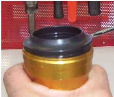
2. Retirez le clips. **ATTENTION : ne pas rayer le tube plongeur et le fourreau.**
