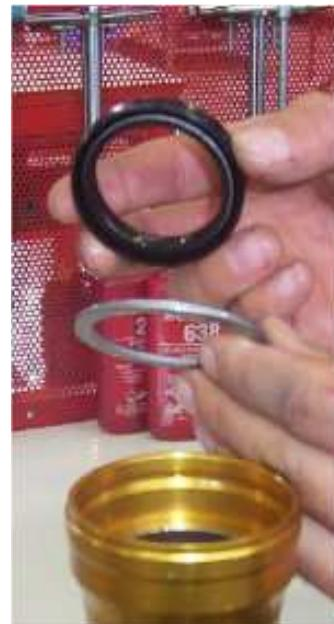
5. Bloquez le fourreau dans un étau. Pour retirer la bague inférieure, chauffez-le fourreau à proximité du joint spy à 50/60°C environ. Retirez la bague en tapant sur le fourreau.
