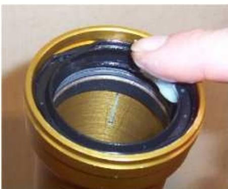
11. Positionnez le clips en le poussant légèrement puisqu'il sert à précharger le joint spy. Vérifiez que tous les cotés du clips soient bien positionnés dans la gorge.
