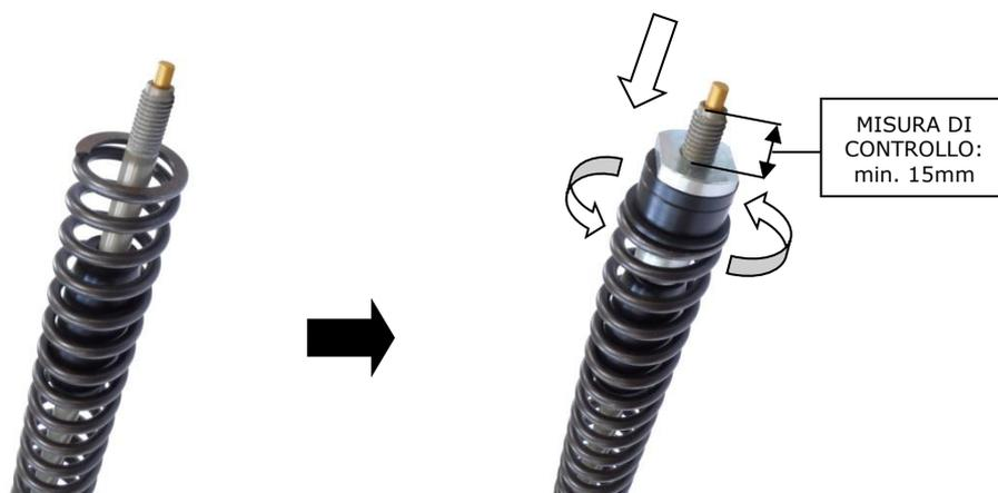
10. Avvitare manualmente il tappo superiore fino a portarlo in battuta sul manicotto precarico. Serrare il tutto alla coppia di serraggio di 9Nm eseguendo al contrario le operazioni svolte al punto **4**.
