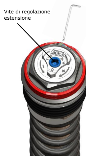
Gambale con la regolazione dell'estensione (DESTRO)
