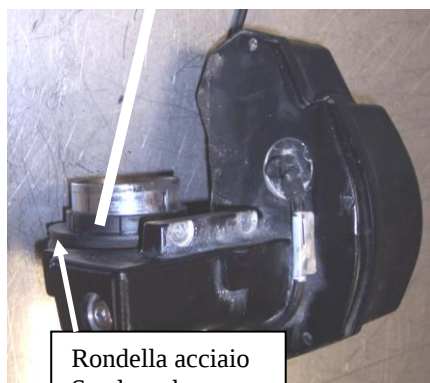
Distanziale Bitubo (lato precarico)/ spacer Bitubo (spring preload side) / Entretoises Bitubo (de précharge côté)
