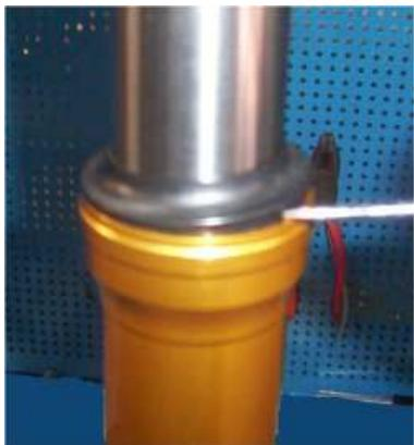
2. Retirez le clips. **ATTENTION : ne pas rayer le tube plongeur et le fourreau.**
