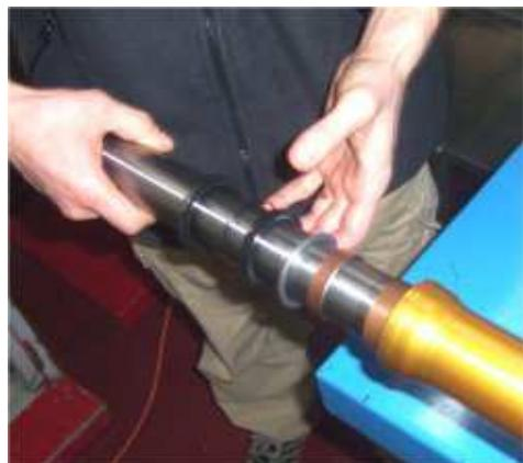
4. Pour retirer le joint spy et le cache-poussière, protégez le tournage du tube plongeur, pour éviter
