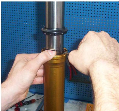
3. Bloccare saldamente il piedino in morsa, scaldare il fodero nella zona paraolio a circa 50/60°C. Estrarre lo stelo eseguendo alcuni colpi in trazioni di massima estensione. Rilevare la esatta sequenza dei componenti lungo lo stelo. **Attenzione: per evitare di danneggiare la boccola superiore, eseguire l'operazione senza l'utilizzo di attrezzi come battenti assiali o martelli.**
