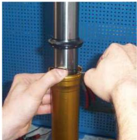
3. Bloquez le fourreau dans un étau, chauffez-le à proximité du joint spy à 50/60°C environ. Retirez le tube plongeur du fourreau par à-coups successifs. **Attention: ne pas utiliser de marteaux.**
