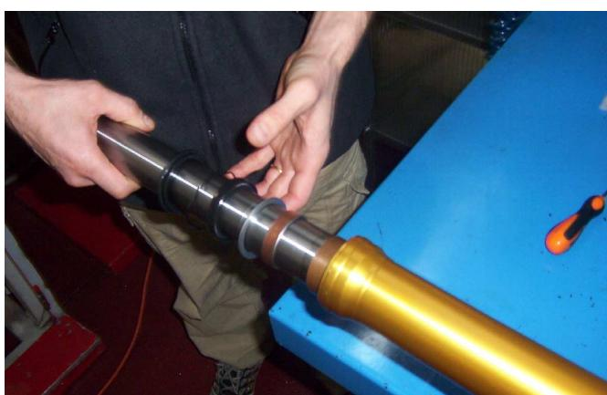
4. Per estrarre il paraolio e raschiapolvere è assolutamente necessario proteggere la tornitura sullo stelo per non daneggiare il paraolio nel passaggio: ricoprire la zona con pannocarta o nastro teflonato.
